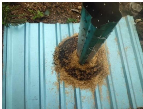
Gambar 3. Cerobong dan proses pembakaran sekam padi
