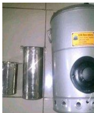
Gambar 5. Kompor briket yang digunakan
