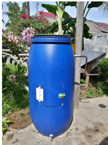
Gambar 4. Rancangan TONGPOSCAH (Tong Komposter dan Pencacah)
