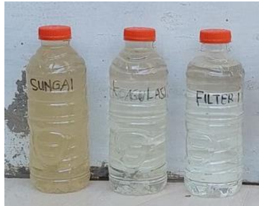
Gambar 4. Air sungai Desa Tinggiran II Luar sebelum dan setelah adanya proses Filter + Membran
