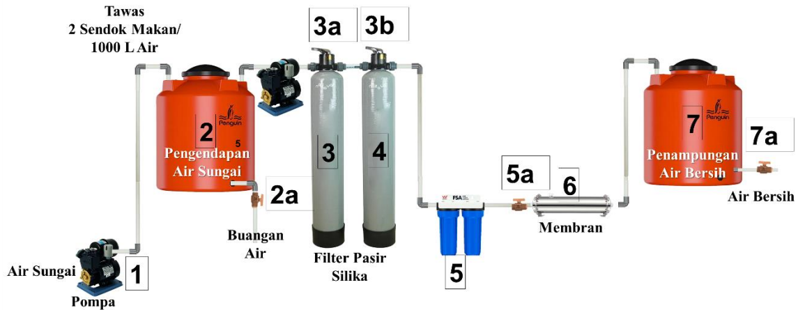
Gambar 1. Skema Alat Filtrasi + Membran di Desa Tinggiran II Luar
