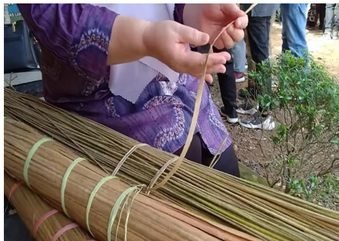
Gambar 1 (b). Pemilihan material standar hasil pemipihan yang tidak pecah serta memilih ukuran lebar yang sama untuk hasil anyaman yang berkualitas
