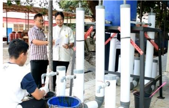
Gambar 6. Alat Reaktor Anaerobik
