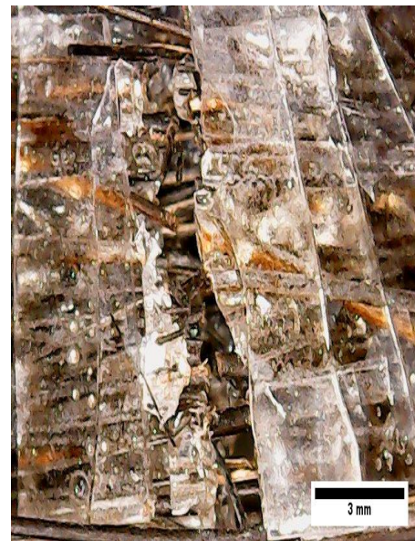
Gambar 6. Foto mikro patahan spesimen komposit komposisi 50:50
