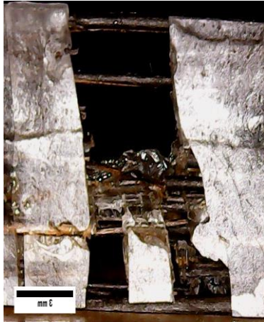
Gambar 4. Foto mikro patahan spesimen komposit komposisi 30:70
