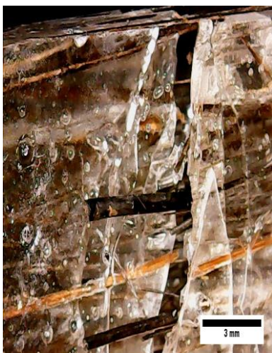
Gambar 5. Foto mikro patahan spesimen komposit komposisi 40:60
